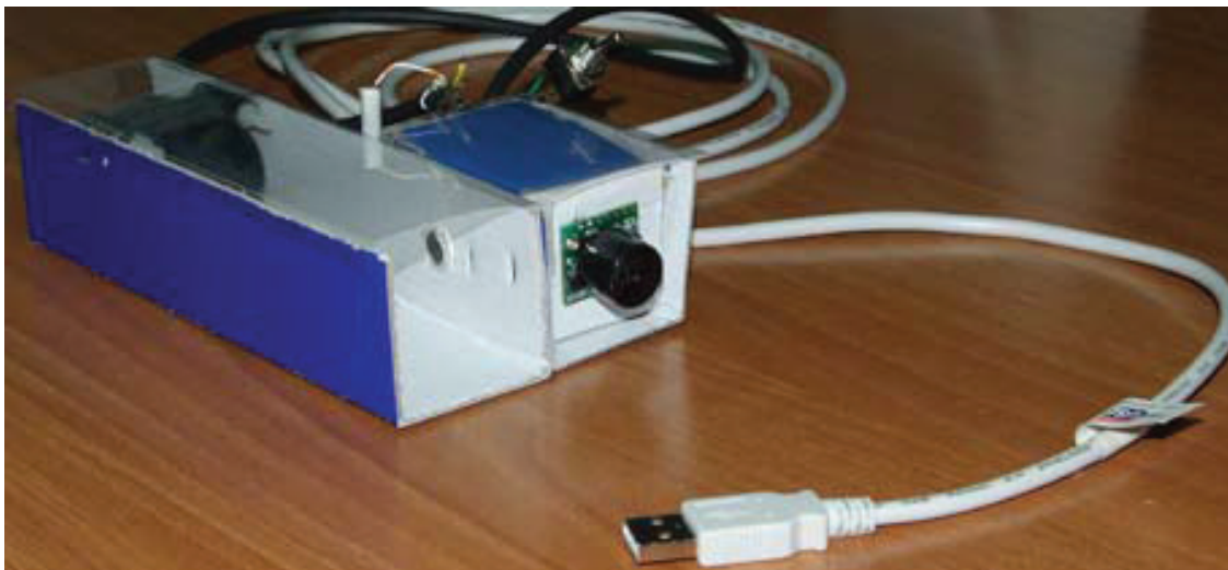
Figura 4. Student Presence Detector per la rilevazione dello studente. Il sistema si compone di un misuratore di distanza, un blocco di lettura della qualità dell'aria e di un meccanismo di gestione della ventilazione.
